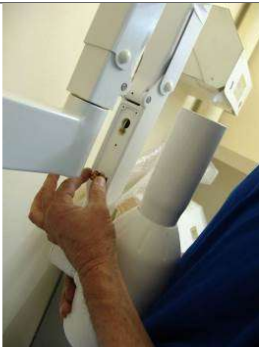
25. חבר את כיסויי הפלסטיק לאלקטרוניקה ולאדפטור, והחזר את פסי הלוגו למקומם.
