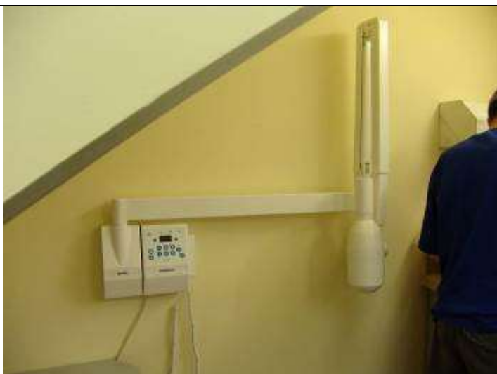
26. גזור את הפלסטיק המחזיק את זרוע המספריים, כוון את החיכוך כך שראש הרנטגן יוכל לעצור בכל פוזיציה ללא גלישה
